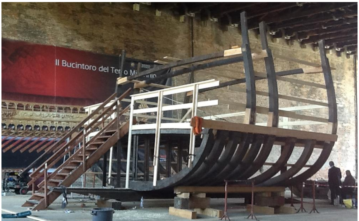
FIG. 4.30 Sezione del Bucintoro. Fonte: www.fondazionebucintoro.wordpress.com
